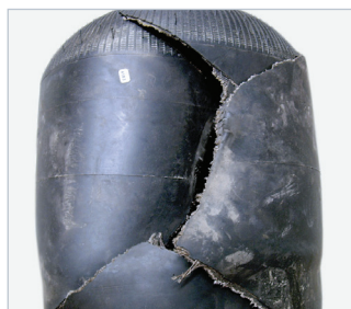
Obr. 5: Prasklá napodobenina měchu vzduchového pérování
