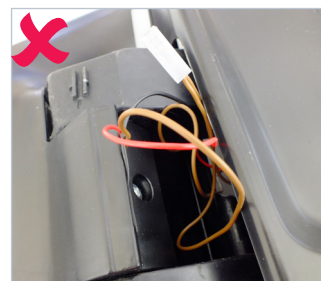
Obr. 9: Srovnatelný výrobek s obnaženými kabely
