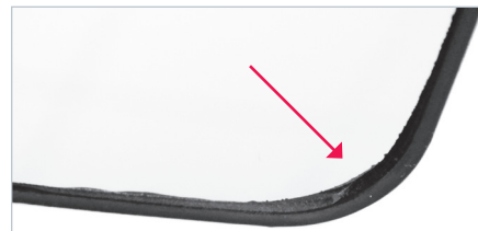
Obr. 4: Špatná koncová úprava hran
