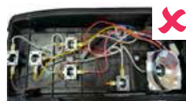
Obr. 5: U neoriginálního výrobku je vedení uvolněné.
