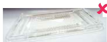
Obr. 7: Světlo neoriginálního výrobku bez těsnění
