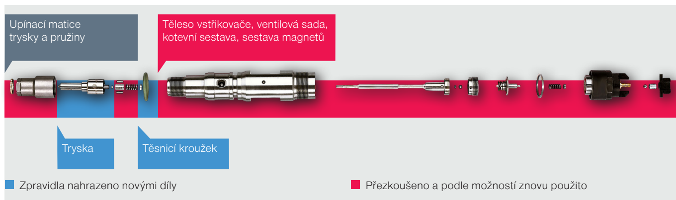
Obr. 5: Rozsah prací při údržbě v běžném autoservisu
