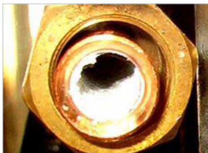
Obr. 4: Usazeniny granulátu v klimatizačním systému způsobené přesycením filtračním vysoušečem
