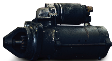
Obr. 2: Originální startéry MAN – před procesem renovace
